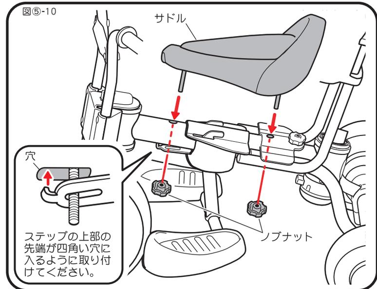
・ステップの上部をフレーム金具の穴に入れ、後ろへずらして引っかけてください。
