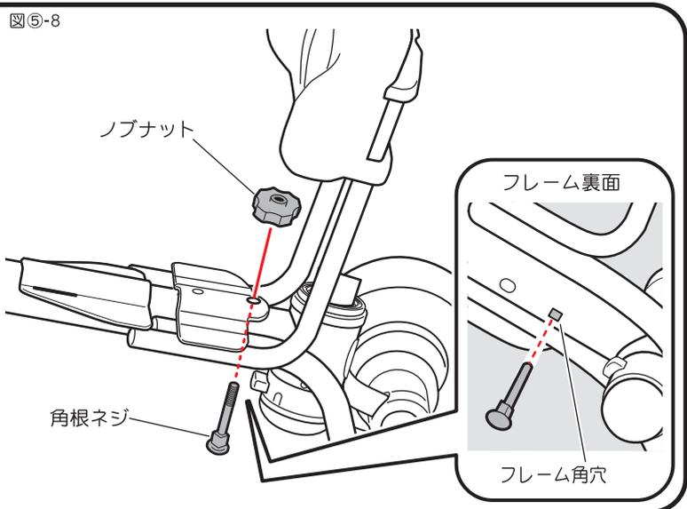
・背もたれのパイプ先端がフレーム金具の下になるようにセットしてください。
