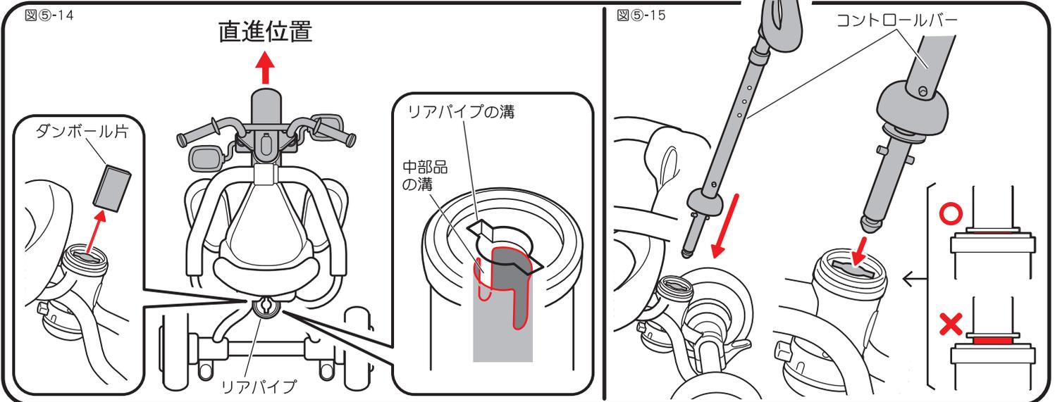
・フレームパイプ内部の部品を固定するダンボール片を引き抜き、ハンドルを直進位置(左右に曲げない)にして、リアパイプの溝と中部品の溝が合っていることを確認してください。溝がズれているとコントロールバーが入りませんのでご注意ください。
