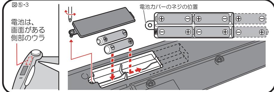
・電池は画面がある側部のウラ側です。ネジをドライバーでゆるめて電池カバーを外してください。単三乾電池6本を上図のように入れて、電池カバーを取り付けてください。
