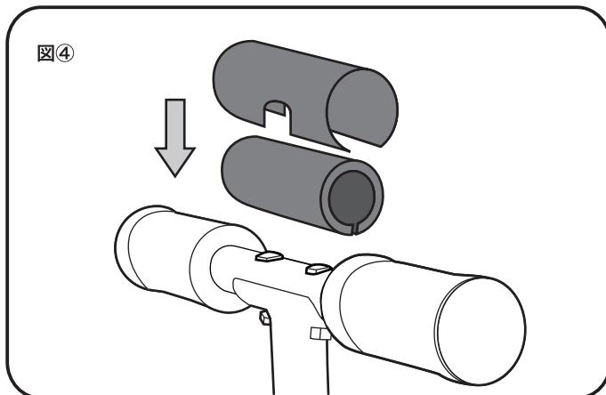
2 バーパッドをハンドルを包むように取り付けてください。バーパッドを取り付けたらその上からバーパッドカバーを巻きつけてください。
